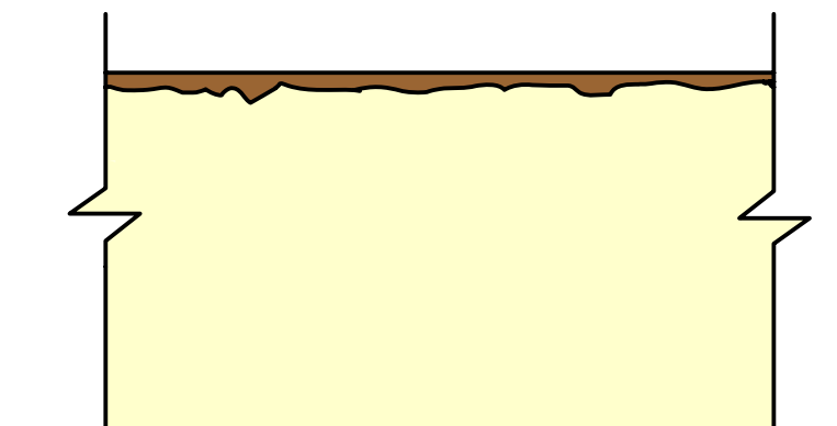
Figura 2.34 – Destacamento da argamassa no topo do muro – Adaptada de THOMAZ, 1996
